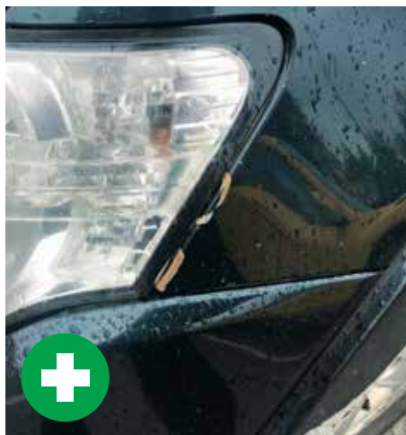
Отслоения ЛКП , появившиеся в результате естественного износа (сколы, пескоструйное воздействие и др.).
